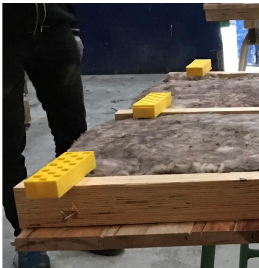
Figur 1 Foto af de to prøvemner. Til venstre: Gul kile/Gul kile. Til højre: Gul kile med lydbrik/Gul kile.
